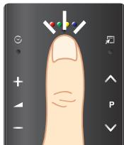
Wenn Sie die Taste oben am Touchpad drücken, können Sie im oberen Bereich des Bildschirms die Farbtasten sowie die Tasten für die Wiedergabesteuerung und zum Schließen anzeigen.
