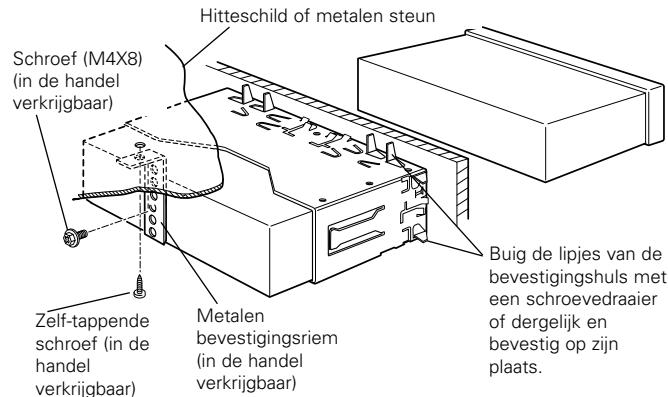
Kontroleer dat het toestel goed op zijn plaats is geïnstalleerd. Het toestel zal niet juist functioneren indien het niet goed is geplaatst (het geluid zal bijvoorbeeld overslaan).
