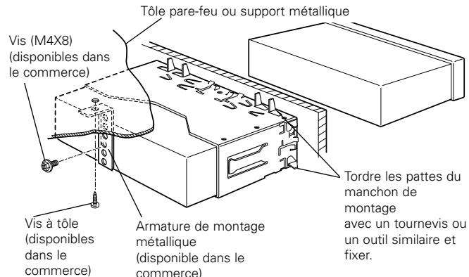
Assurez-vous que l'appareil est solidement installé. Si l'appareil est instable, il risque de mal fonctionner (ex. le son risque de sauter).
