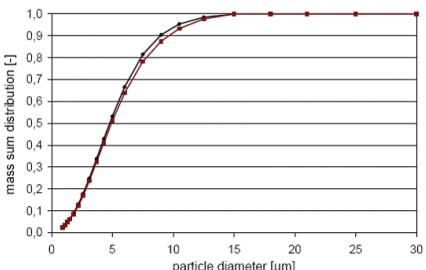
Die Messungen wurden mit einer Natrium-Chlorid-Lösung, mittels Laser-Diffraktions-Methode durchgeführt.
