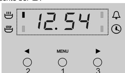
Ist die eingestellte Zeit abgelaufen, schaltet der Backofen automatisch ab, ertönt ein Signalton, und die Leuchte bei
