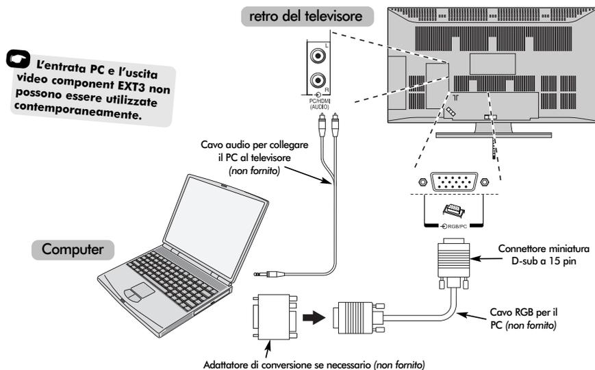
Collegare il cavo del PC proveniente dal computer al terminale PC sul retro del televisore.
