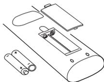
Retire la tapa posterior para dejar al descubierto el compartimiento de las pilas y asegúrese de que las pilas se colocan en la posición correcta. Los tipos de pilas correctos para este mando a distancia son los AAA, IEC R 03 de 1,5 V.
