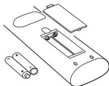
Rimuovere il coperchio posteriore del telecomando per esporre lo scomparto batterie, ed assicurarsi che le batterie siano inserite nel senso giusto. I tipi di batterie da 1,5 V adatte per questo telecomando sono AAA IEC R03.
