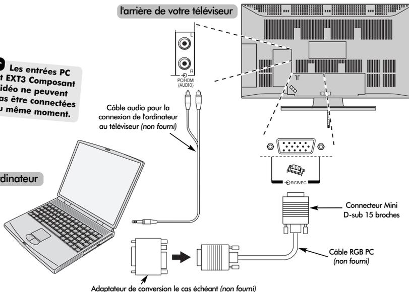
Connectez le câble d'ordinateur de l'ordinateur à la borne PC à l'arrière du téléviseur.
