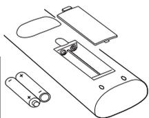
Retire a tampa traseira para aceder ao compartimento das pilhas e certifique-se de que as pilhas são colocadas no sentido certo. As pilhas adequadas para este comando são AAA, IEC R03 1,5V.
