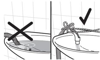
– Zum Einhängen in ein Waschbecken bzw. eine Badewanne muss der Ablaufschlauch mit dem mitgelieferten, aufsteckbaren Krümmer gegen Abrutschen gesichert werden. Die Rückstoßkraft des auslaufenden Wassers kann sonst den Schlauch aus dem Becken drücken.
